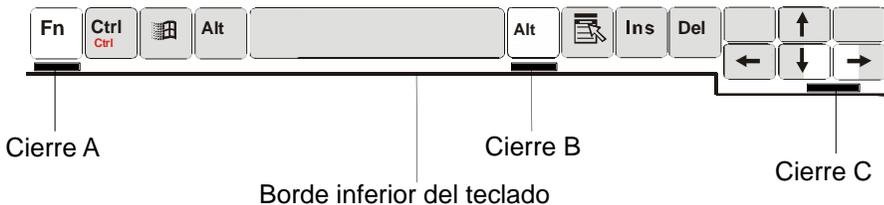
5. Utilizando una hoja pequeña para apretar el cierre A hacia abajo, el teclado se levantará ligeramente sobre el cierre. Si el teclado no se levanta, pruebe a levantarlo sobre el cierre. Repita el paso para los otros cierres del teclado.
